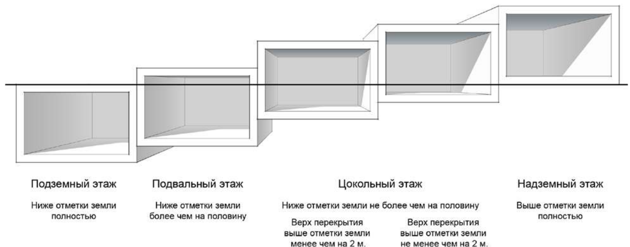
Рис. 5. Сравнение подземного, подвального, цокольного и надземного этажа 1
