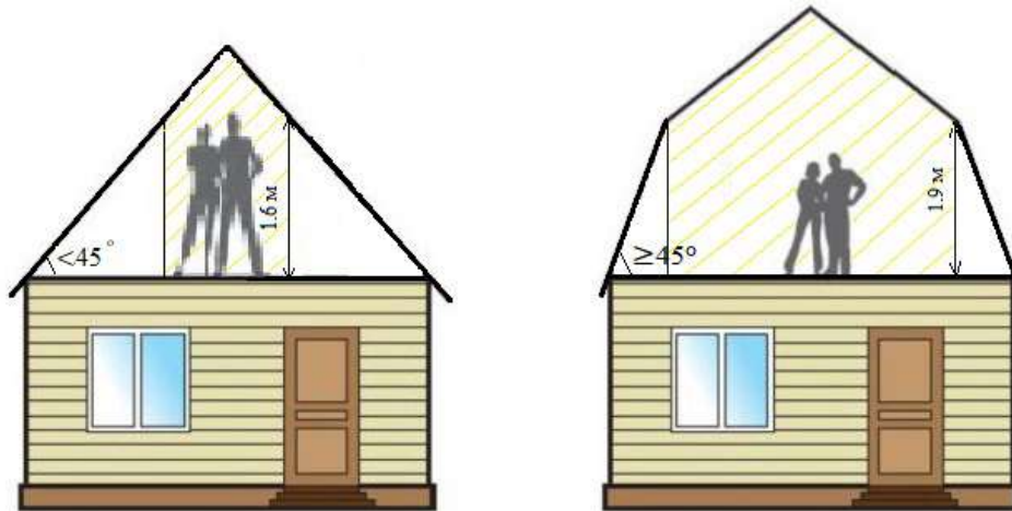
Рис. 8. Определение площади мансардного этажа жилого здания
