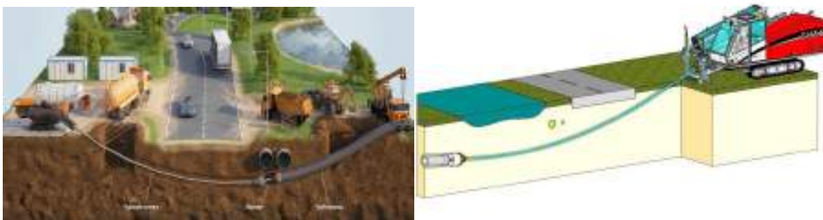
Рис.48. Безтраншейный способ укладки кабеля с помощью кабелеукладчиков или установок горизонтально направленного бурения (ГНБ)
