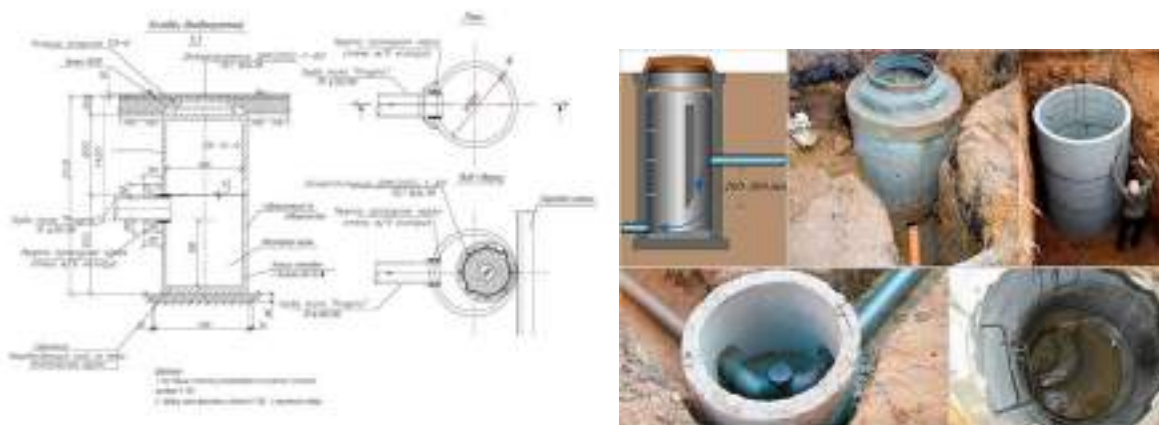
Рис.44. Устройство смотрового колодца.
