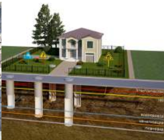
Рис.40. Схема прокладки инженерных сетей в разрезе
