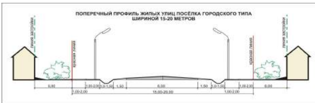
Рис.13. Поперечный профиль улицы
